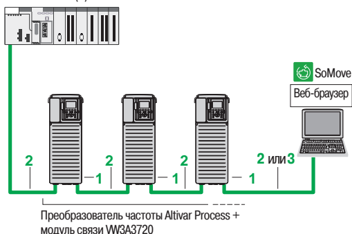
Пример подключения преобразователей частоты по сети EtherNet/IP
